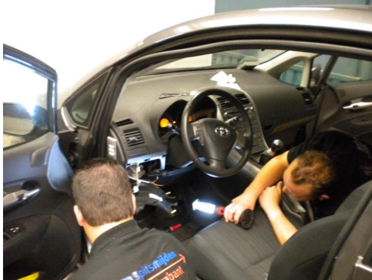
figuur 3.2 Inbouw van een OBU in de auto van een nieuwe deelnemer
