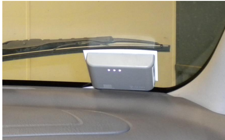
figuur 2.3 Een ingebouwde On-Board Unit (OBU) achter de voorruit van een deelnemende auto
